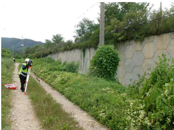
광파기를 이용한 측량 작업
