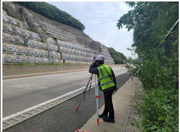
광파기를 이용한 경사도 측정
