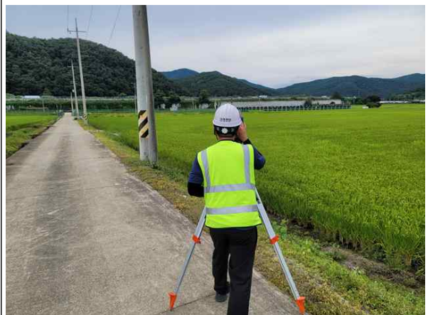
광파기를 이용한 경사도 측정
